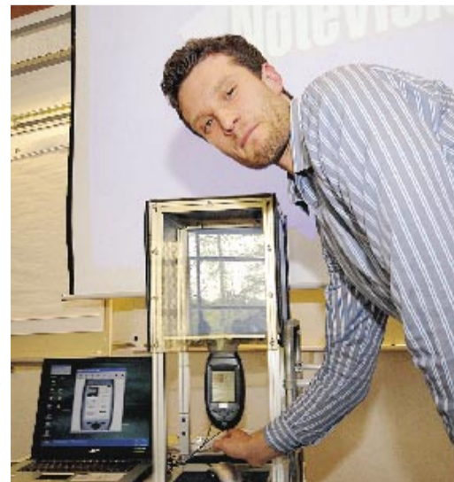
Oskar Lindström demonstrerar ED-XRF-utrustningen som med röntgenstrålar avslöjar vilka grundämnen som ingår i en konstruktion.
